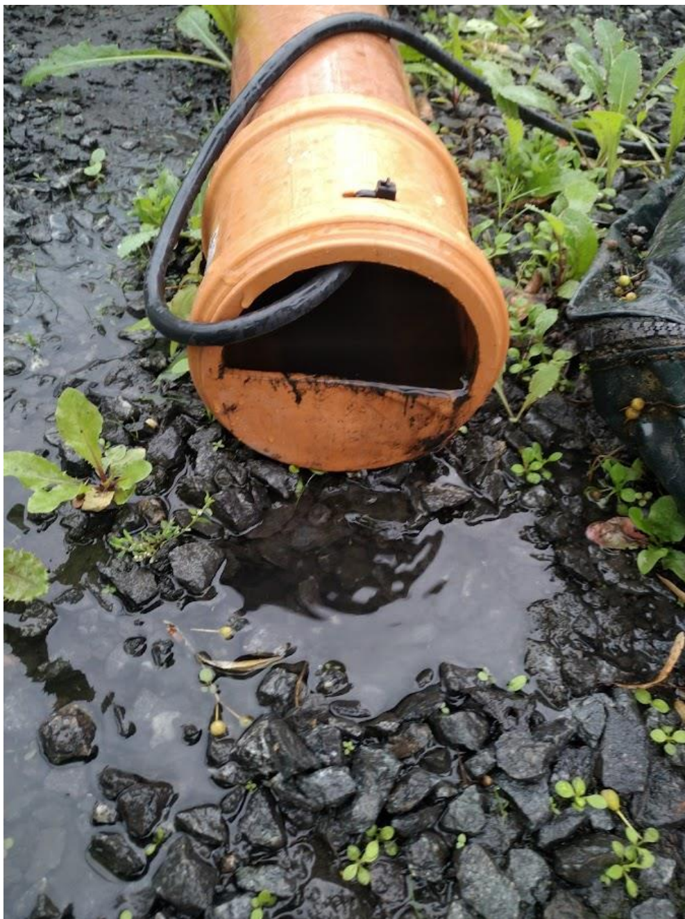
Figur 15 Mätning flöde, inlopp R1. Givare och mikro-skibord.
