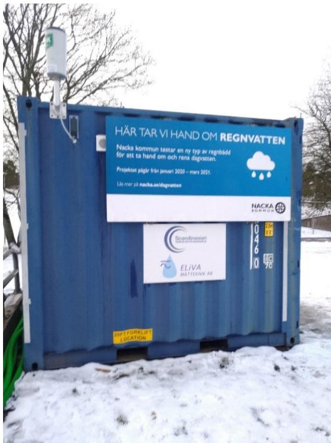
Figur 10 Provtagningscontainer med nederbördsräknare på taket.
