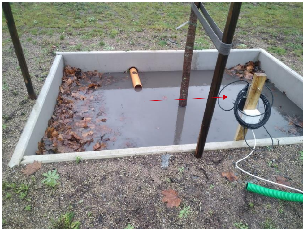
Figur 14 Bräddmätning R1 och R3.
